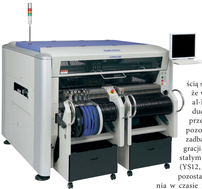
Automat do montażu SMD Yamaha I-Pulse M20
