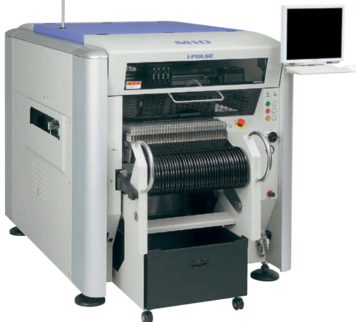
Automat do montażu SMD Yamaha i-Pulse M10
