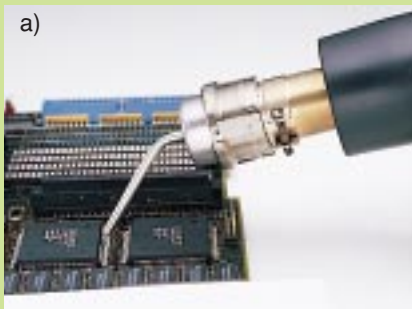
Rys. 6. Demontaż układów przy użyciu ręczki ThermoFlo
