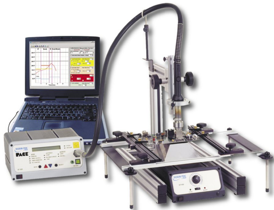
Zestaw montażowo/demontażowy SMT/BGA oparty na PACE ST-325
