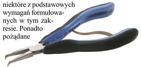
Rys. 2. Zaokrąglone kształty rękojeści ułatwiają obracanie szypiec i obcinaczek w dłoni, a plastyczny elastomer gwarantuje pewny chwyt. Sprężyna jest regulowana; jej charakterystyka zapewnia minimalne obciążenie dłoni
