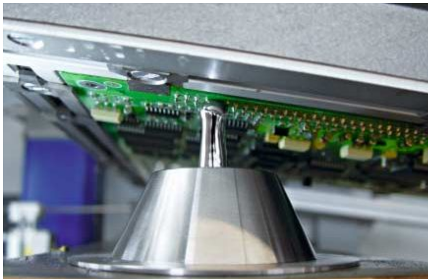
Proces lutowania dyszą zwilżającą (jednorodny rozplływ we wszystkich kierunkach)
