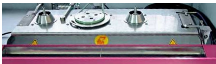
Tygiel lutowniczy z dwiema dyszami i podgrzewaczem IR
