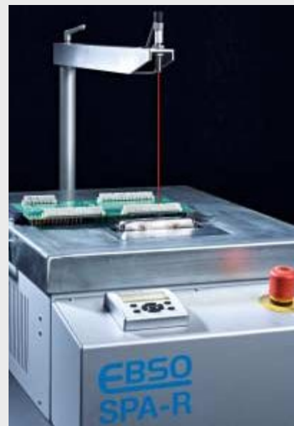
SPA-R z laserowym wskaźnikiem do centrowania komponentu względem dyszy
