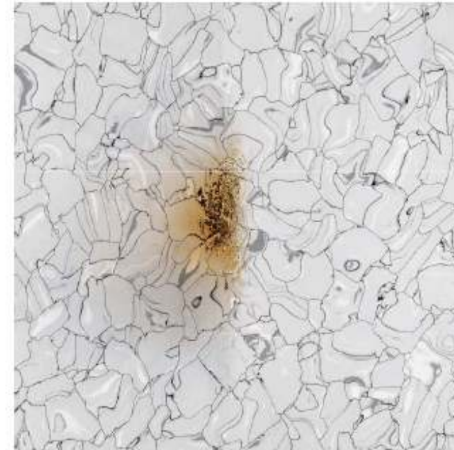
Uszkodzenia chemiczne oraz przypalenia
